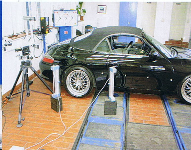
Warmes Licht: Strahlungsstarke Halogenlampen bringen Wärmeenergie in das Prüfobjekt ein, eine Infrarotkamera misst dabei den Wärmeverlauf.
