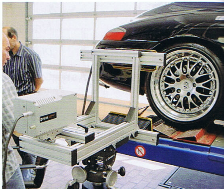
Abgeblitzt: Alternativ können extrem strahlungsstarke Impulsblitzlampen die Karosserie aufwärmen, das System ist jedoch etwas teurer als die Halogen-Version.
