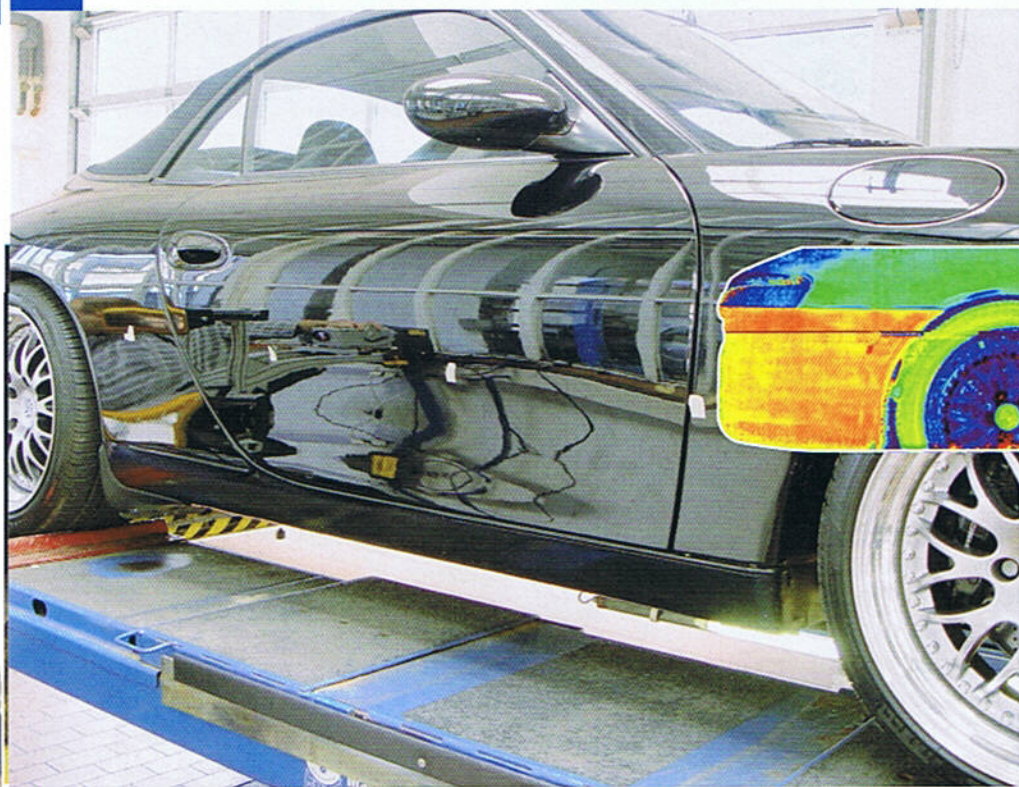
Alles glänzend: Von außen präsentiert sich der Lack dieses Fahrzeugs ohne erkennbaren Makel. Das Thermografiebild (unten) spricht eine andere Sprache. Bilder: Carl Messtechnik und Prüfsysteme
